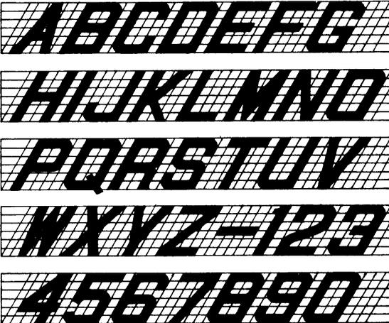
Maximale Schrägstellung höchstens 30° rechts von der Senkrechten
