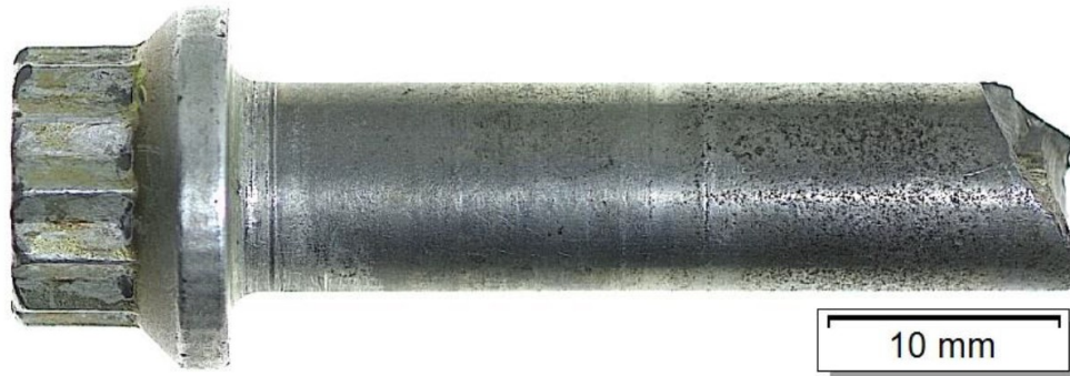
Abbildung 4: Gebrochener Befestigungsbolzen mit auffallend narbiger Oberfläche im Bruchbereich.
