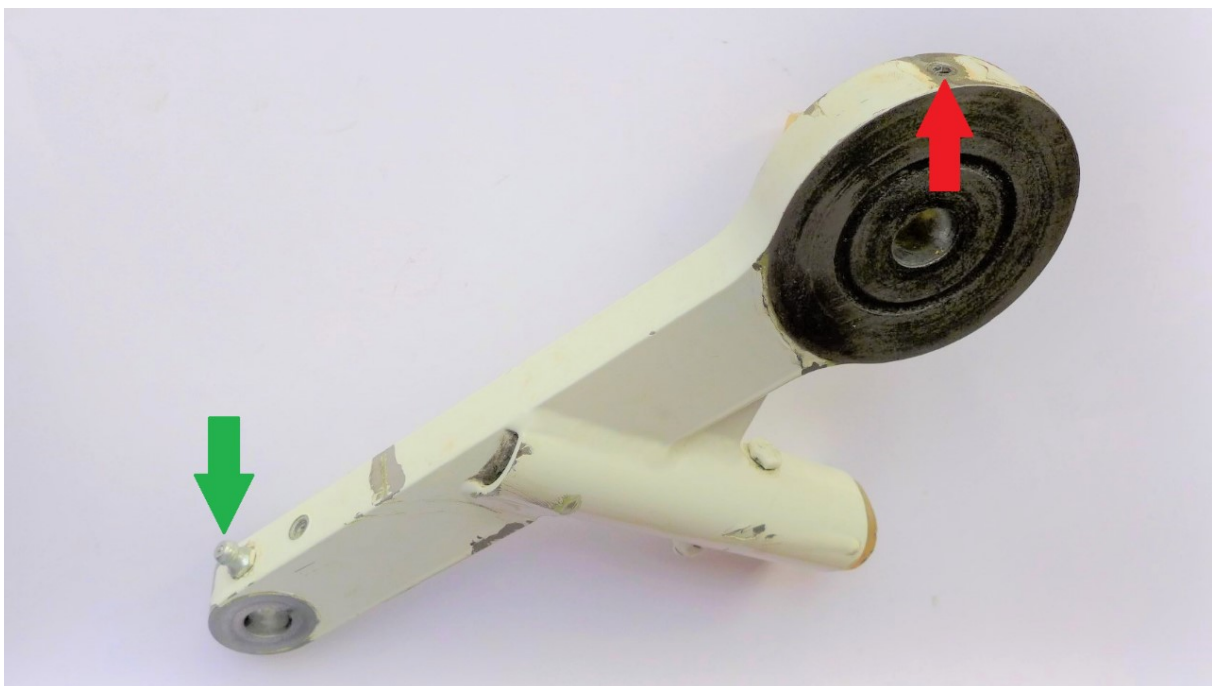
Abbildung 5: Oberer Arm des torque link mit einem intakten Schmiernippel (linker grüner Pfeil) und dem abgebrochenen und mit einer Feile bearbeiteten Schmiernippel des betroffenen Gelenks (rechter roter Pfeil).
