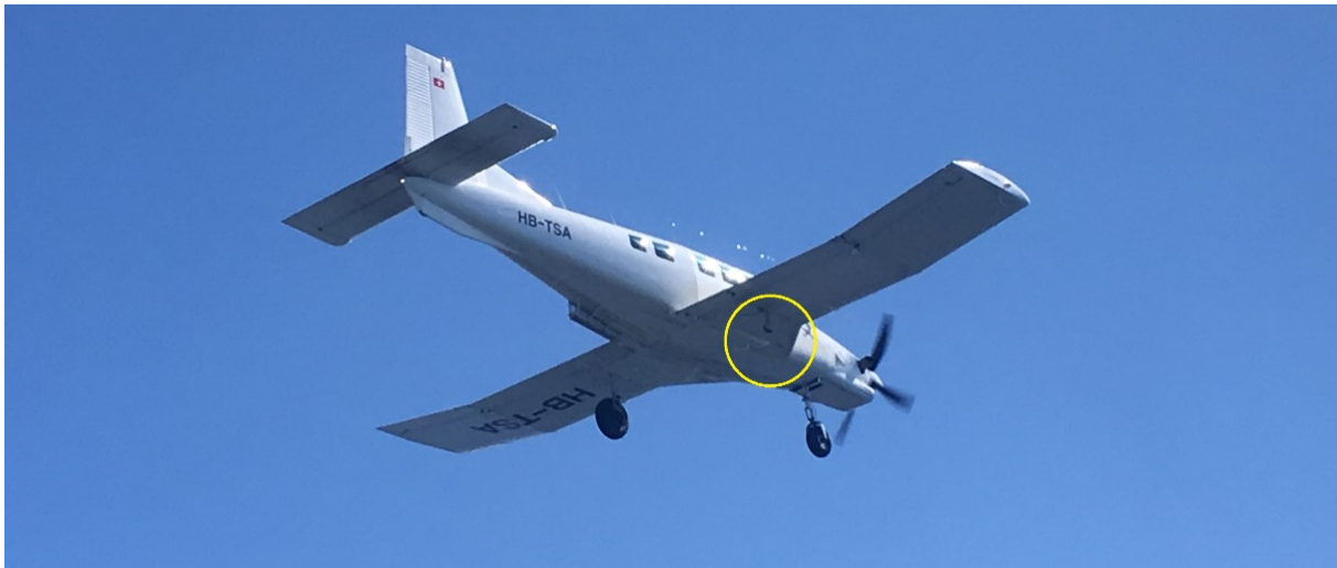
Abbildung 1: Die HB-TSA mit dem Fahrwerkstummel ohne Rad (gelber Kreis) nach dem Absetzen der Fallschirmspringer, aufgenommen aus einem Flugzeug der Schweizer Luftwaffe.
