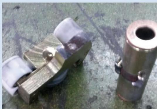
Das unerwartete Öffnen der Tür der Kabine Nr. 15 bei der Ausfahrt aus der Talstation wurde durch den Bruch des Führungswagens am Kabinentürflügel verursacht.
