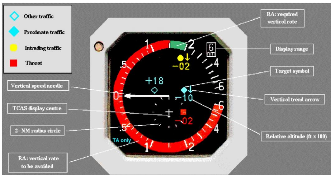
**Abbildung 3:** Prinzip-Darstellung eines kombinierten Variometers mit Anzeige für Verkehrswarn- und zur Kollisionsverhinderung. Die relativen Höhenangaben anderer Luftfahrzeuge, die mit einem Höhen übermittelnden Transponder ausgerüstet sind, erfolgen in Hektotfuss. Links unten erscheint die Anzeige „TA only“ (blau), falls sich das TCAS im reduzierten Modus *traffic advisories only* befindet.
