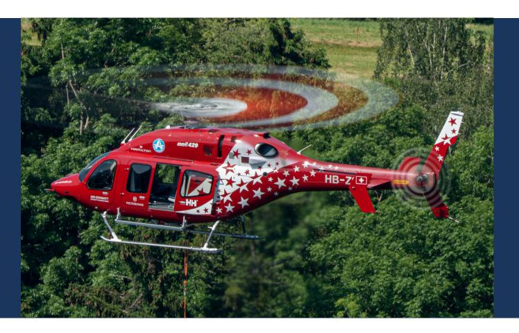
In der Schweiz wird die Bell 429 insbesondere von der Air Zermatt und der Alpine Air Ambulance in der Rettungs-Heli Konfiguration inkl. 90m langer Rettungswinde eingesetzt. Durch die flache Kabine und ein Schienensystem kann die Maschine innert kürzester Zeit vom VIP- zum Rettungshelikopter umgebaut werden und deckt somit eine grosse Bandbreite an Missionen ab.
